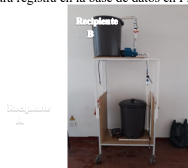
Fig. 3. Prototipo de un laboratorio remoto de Mecánica de Fluidos.
